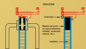
Notre modèle Amazone est un type de Battant de porte en bois avec des choix esthétiques, de couleur, dessin et structure conçu pour utilisation dans des espaces fermés. Des battants d'un épaisseur de 40 mm peuvent être fabriqués en lamier, mdiflam, revêtement naturel ou en vernis. Adapté aux types de murs tels que panneaux de gypse, béton cellulaire, brique, etc., ce modèle peut être utilisé avec toutes sortes d'accessoires dans tous les projets d'intérieur.
